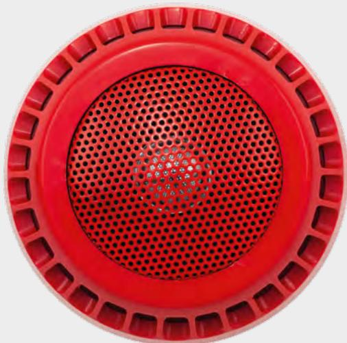
Il dispositivo di allarme vocale SG-PGW3 fornisce un allarme alternato a un segnale acustico (18 pattern disponibili) e un messaggio verbale (sequenza conforme alla norma EN 54-3). Il messaggio verbale può essere programmato semplicemente da PC e inviato alla scheda di memoria del dispositivo tramite cavo micro USB.
