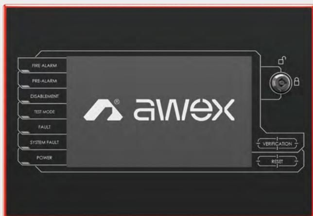
Il pannello ESP consente di azionare la centrale rivelazione incendio da un punto lontano rispetto la sua ubicazione fisica, replicandone l'interfaccia. Visualizza messaggi di allarme, guasto, blocco e test. La centrale FAS può essere installata dove è più conveniente in termini di topologia dell'impianto, mentre il pannello remoto può essere posizionato vicino al personale addetto al funzionamento del sistema che può verificare e annullare gli allarmi secondo il proprio livello di accesso.
