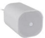
Il **DF-AH50T** è un **altoparlante sospeso da interno ed esterno** in alluminio estruso verniciato. È dotato di altoparlante a larga banda da 127 mm (5"). Il **DF-AH50T** include un trasformatore per operare in sistemi a tensione costante 100V e 70V con tre livelli di potenza.
