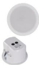
Il **DF-AC61T** è un **diffusore da soffitto HI-FI** con telaio in ABS e griglia in alluminio verniciata. È dotato di woofer da 154 mm (6 ") ed tweeter a cupola da 1". Include un trasformatore per operare in sistemi a tensione costante 100V e 70V. Il cabinet è chiuso da un coperchio in materiale plastico ignifugo.
