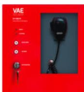
La **DF-DBEVF** è una Base VVF completamente monitorata **secondo normative EN54-16**, box metallico da parete colore rosso, led di stato, microfono palmare programmabile da software e accesso alle funzioni di allarme mediante chiave di sicurezza. Tasto attivazione remota messaggi "EVAC" e "ALARM".
