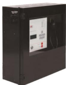
Il **sistema di allarme vocale DF-991** è un apparato per la segnalazione di messaggi di emergenza e evacuazione in caso di incendio. Il DF-991 è progettato e certificato secondo le **Norme EN54-16 ed EN54-4**. È un sistema integrato, monolitico, che include in un unico contenitore sia i blocchi propri del sistema di allarme vocale, sia l'alimentatore con batterie di riserva.
