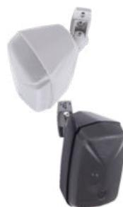
La **DF-A51T** è una **linea di diffusori sonori compatti, a due vie, per installazione superficiale**. Progettati per applicazioni a tensione costante o impedenza costante. Corredati di un Woofer da 76 mm (3 ") e un Tweeter a cupola da 1". Muniti di trasformatore per operare su sistemi con tensione costante a 100 V e 70 V. Sul pannello posteriore: selettore a rotazione per regolare la potenza o impedenza, morsettiera in ceramica e fusibile termico, in conformità alla norma **EN 54-24: 2008**.
